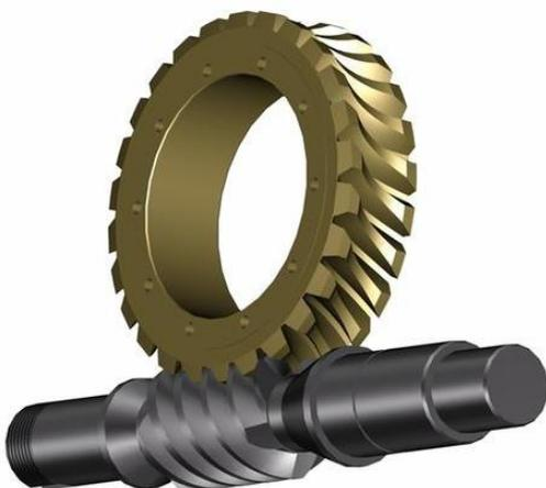
Die Schneckenradstufe besteht aus einer einsatzgehärteten dreigängigen Schnecke (6) mit geschliffenen Zahnflanken und einem Schneckenrad (7) mit einem Zahnkranz aus Schleuderbronze. Diese Werkstoffpaarung gewährleistet bei guten Gleiteigenschaften niedrigen Verschleiß und damit hohe Lebensdauer. Schnecke und Schneckenwelle sind als ein Teil ausgeführt.
